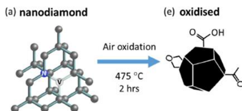
Figura 18 – Protocolo descrito por Simpson e colaboradores para a oxidação térmica de NDs (Fonte: Adaptado de Ryan et al. 2018)
