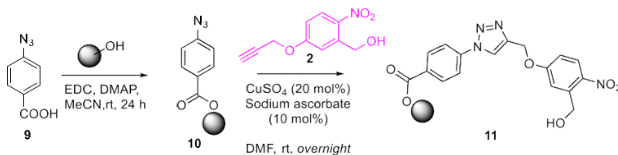
Equation 12. Imobilização do grupo fotorremovível em duas etapas: obtenção da azida seguida de click chemistry
