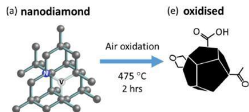
Figure 7-34. Protocolo descrito por Simpson e colaboradores para a oxidação térmica de NDs (Fonte: Adaptado de Ryan et al. 2018)
